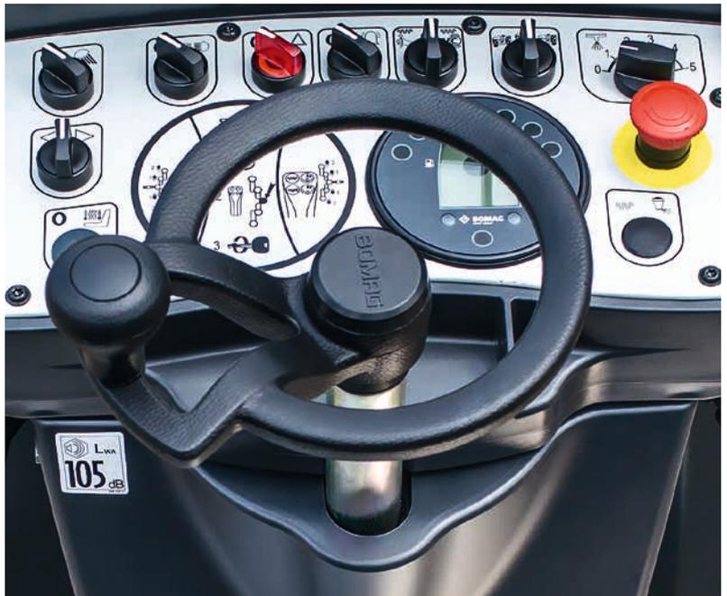
Los interruptores grandes, un volante compacto y la colocación clara de todos los elementos de mando facilitan a los operarios el trabajo con un rodillo tándem ligero de BOMAG.
