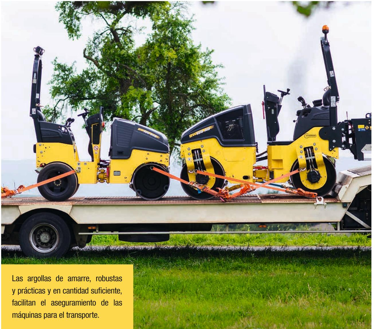
Las argollas de amarre, robustas y prácticas y en cantidad suficiente, facilitan el aseguramiento de las máquinas para el transporte.
