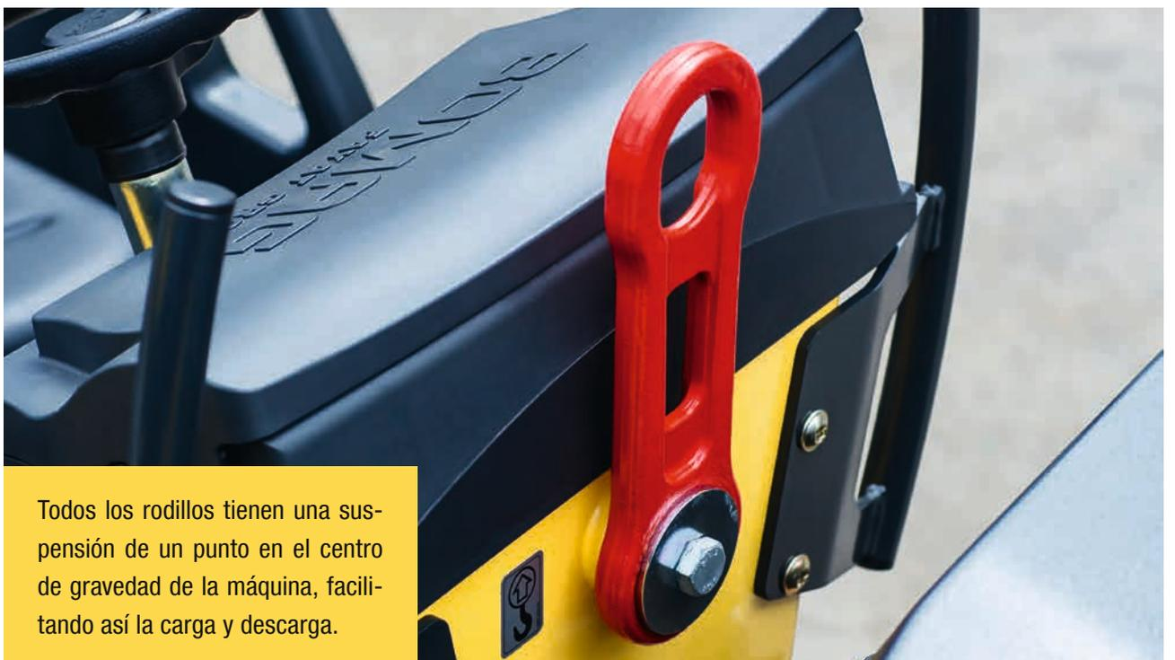
Todos los rodillos tienen una suspensión de un punto en el centro de gravedad de la máquina, facilitando así la carga y descarga.
